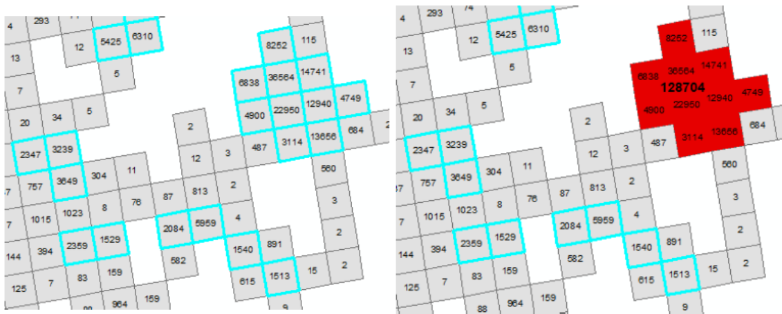
Figura 1. Análisis de contigüidad y población para el cálculo de un centro urbano.
